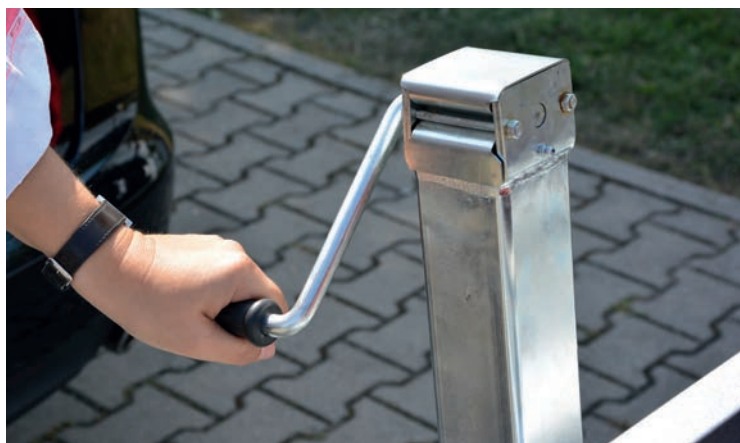
Azionando la manovella è possibile portare facilmente la pedana ribaltabile nella posizione desiderata.
