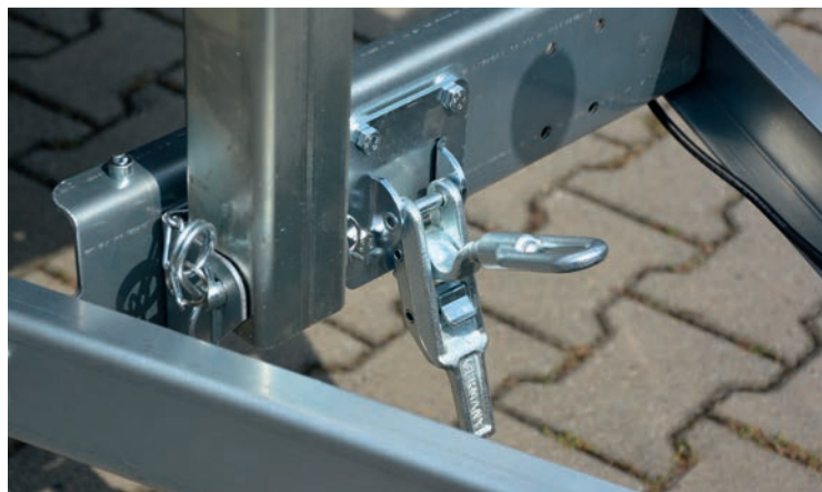
Bloccaggio della pedana ribaltabile tramite chiusura di sicurezza a leva
