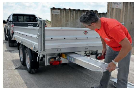
Vano richiudibile per l'alloggiamento delle rampe di carico (opzionale)
