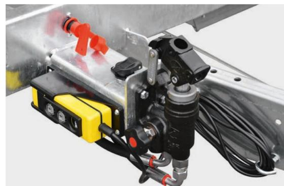
Controllo a distanza, interruttore generale batteria, Pompa manuale d'emergenza
