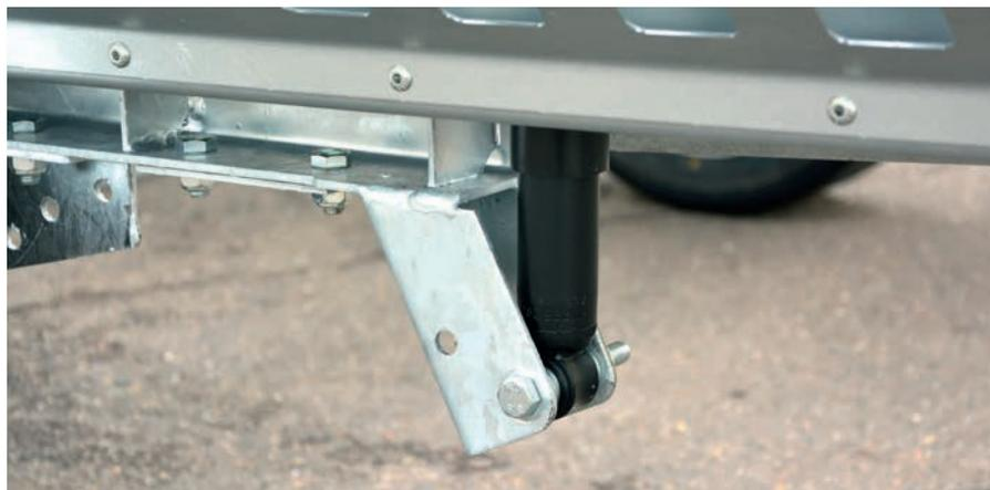
I cilindri idraulici esenti da manutenzione portano la pedana ribaltabile in posizione inclinata.
