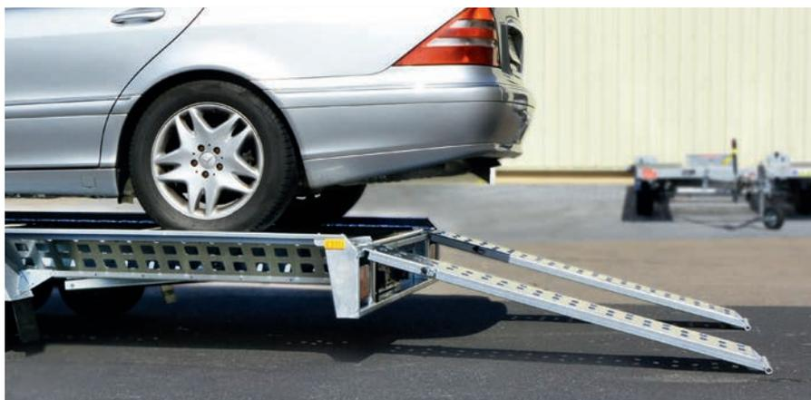
Durante l'inclinazione della pedana le guide di carico mantengono il contatto col terreno.
