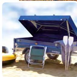
Rimorchio da campeggio | Dimensioni 201 x 108 x 53 cm, capacità di carico 1.250 litri | Allestito col portabicicli può trasportare fino a tre biciclette | Peso complessivo consentito di 750 o 850 kg | Robuste cerniere in acciaio | 2 lucchetti di sicurezza | Verniciatura a polvere di colore blu zaffiro (RAL 5003).
