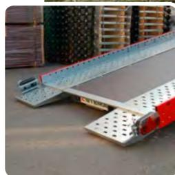
Disponibile sia con pianale alto sia con pianale basso | Rampe di salita e di scorrimento extralarghe | Pompa idraulica manuale a doppia azione | Comportamento silenzioso durante la guida | Robusti punti di ancoraggio | Superficie utile (piano di appoggio): 400x201 cm | Peso complessivo consentito da 2.460 a 3.500 kg | Carico utile: da 1.715 a 2.660 kg | Disponibile con diversi pianali in legno.
