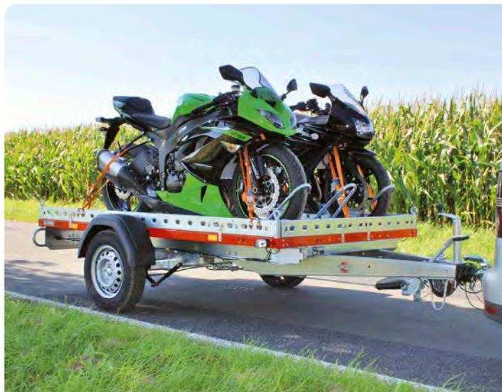
Rimorchio adatto al trasporto da una a tre moto | Bassa superficie di carico | Comprensivo di guide di carico | Comportamento silenzioso durante la guida | Robusti bloccaruota e punti di ancoraggio | La superficie del piano d'appoggio varia dai 194 x 108 ai 307 x 189 cm | Peso complessivo consentito da 750 a 1500 kg | carico utile da 485 a 1.244 kg | Numerosi accessori disponibili come centine, telone alto, sponde laterali.
