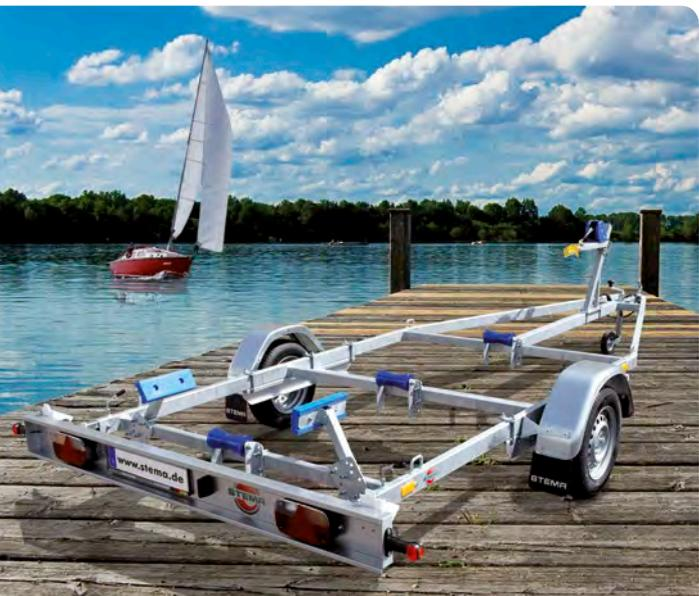
Facilità di varo e alaggio grazie alla traversa fanali rimovibile | Cuscinetti delle ruote impermeabili | Numerosi rulli della chiglia e cuscini d'appoggio | Possibilità di adattarlo alla barca in maniera semplice e personalizzata | Duraturo e sicuro | Peso complessivo consentito 750, 1.300 e 1.500 kg | Lunghezza barca: da 550 a 600 cm | Larghezza rimorchio 219 cm e 244 cm | Numerosi accessori.
