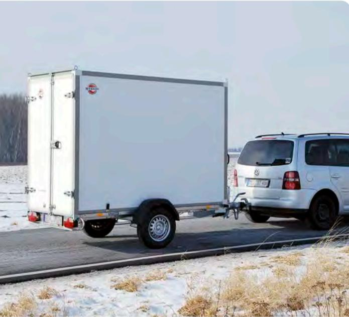
Rimorchio con pianale ribassato disponibile come monoasse o a doppio asse | A seconda del modello il vano bagagli è disponibile in compensato o a sandwich | Spessore compensato: 15 mm | Spessore Sandwich 25 mm | Con robusto telaio in alluminio, rinforzo anti flessione degli angoli | Dimensioni utili (superficie di carico) 251 x 128 cm / 301 x 153 cm | Altezza bagagli 150 mm/185 mm | carico utile 1079/1668 kg.
