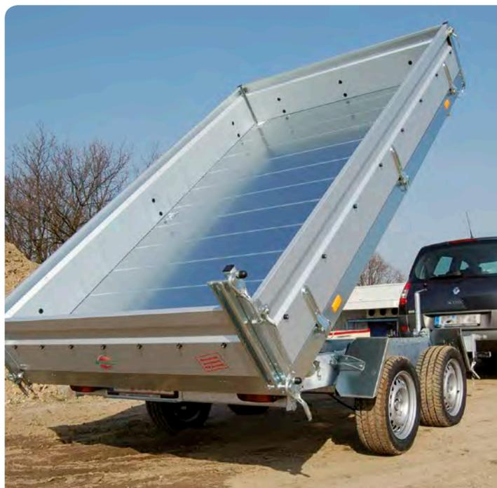
Sponde laterali a doppia parete | Ribaltabile e sollevabile su tutti i lati | Pompa idraulica (elettrica/manuale) | Dimensioni: 301 x 183 x 35 cm | Peso complessivo consentito da 2.500 a 3.500 kg | carico utile da 1.650 a 2.620 kg | Cerniere in acciaio lunghe e robuste | Pannellatura del pianale in GALVALUME® | Attrezzabile con rampe di salita e sovra sponde in griglia.
